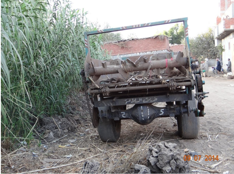
صورة رقم (١٠): صورة لبعض الآلات الزراعية التي تخلط تربة الدلتا الطينية بالتربة الرملية في المحمية
